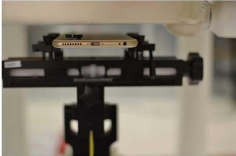
Abbildung 1: Seitenansicht der Körperrückseite mit Cell Shield / Zorb mit DASY-Testsystem
